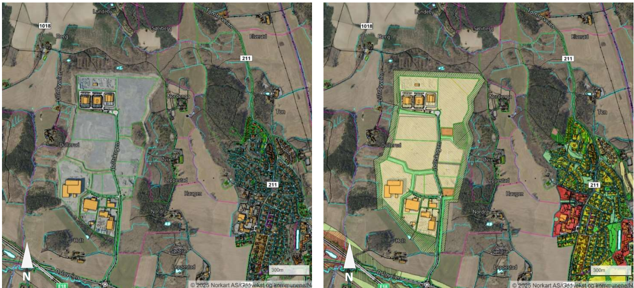
Figur 3 Utklipp fra kommune-web-kart med flyfoto t.v. og gjeldende plankart t.h. fra Indre Østfold kommune, 21.5.2025. Viser at vegetasjon er fjernet i regulerte områder og de er opparbeidet med nytt terreng.
