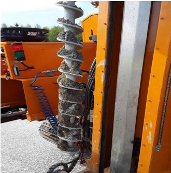
M6 0-1m, grus, sand, stedvis grå. Kan være betongrester
