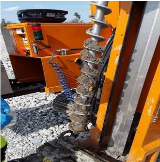
M5 0-1m, sand og grus. Overgang til leire ved 0,8. Leire oksidert, rødfarget
