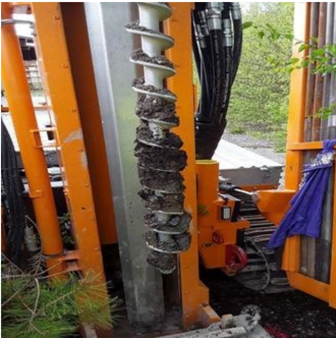
M10 0,5-1m, overgang fra sand og grus til leire ved 0,8 meter.
