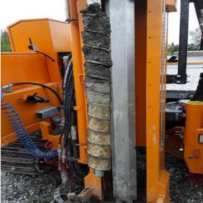
M18 1-2 m. Blanding av leire, sand, grus ned mot 1,5 m, tørrskorpeleire ved 1,5 m og ned
