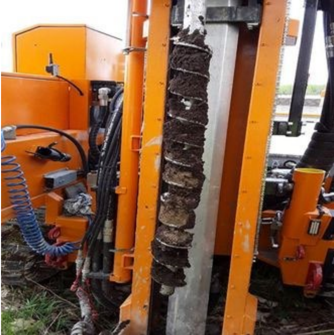
M13 1-2 meter, overgang ved 1,4 m fra sand til tørrskorpeleire
