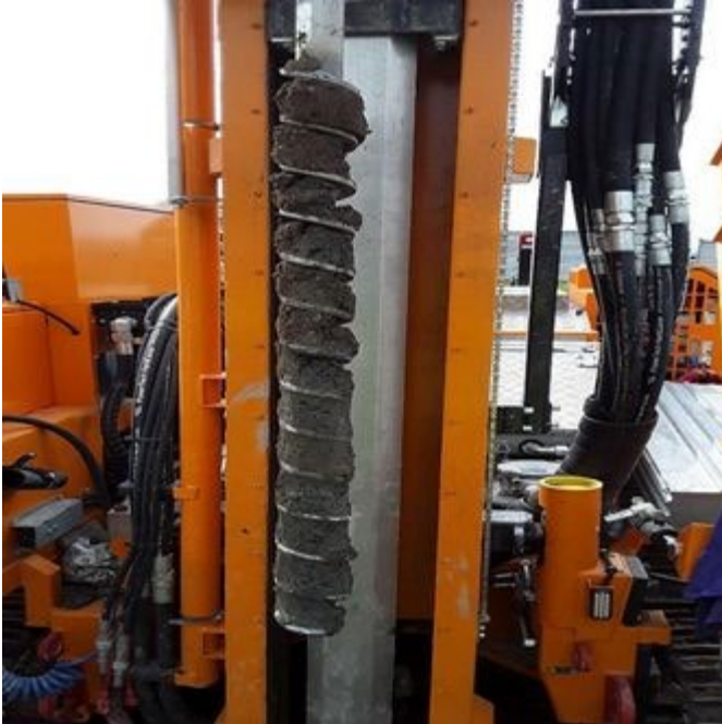
M22 1-2 m, gradvis overgang til leire mot bunn
