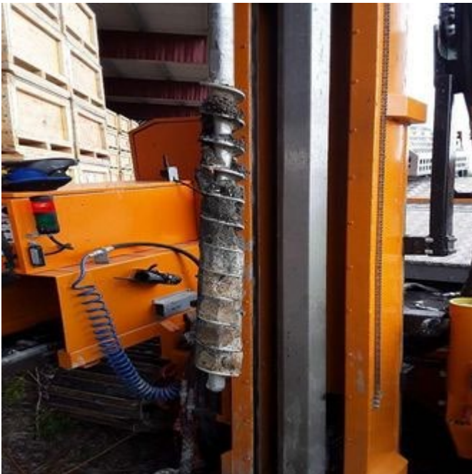
M11 0-1 m, overgang fra sand og grus til leire ved 0,5 meter.
