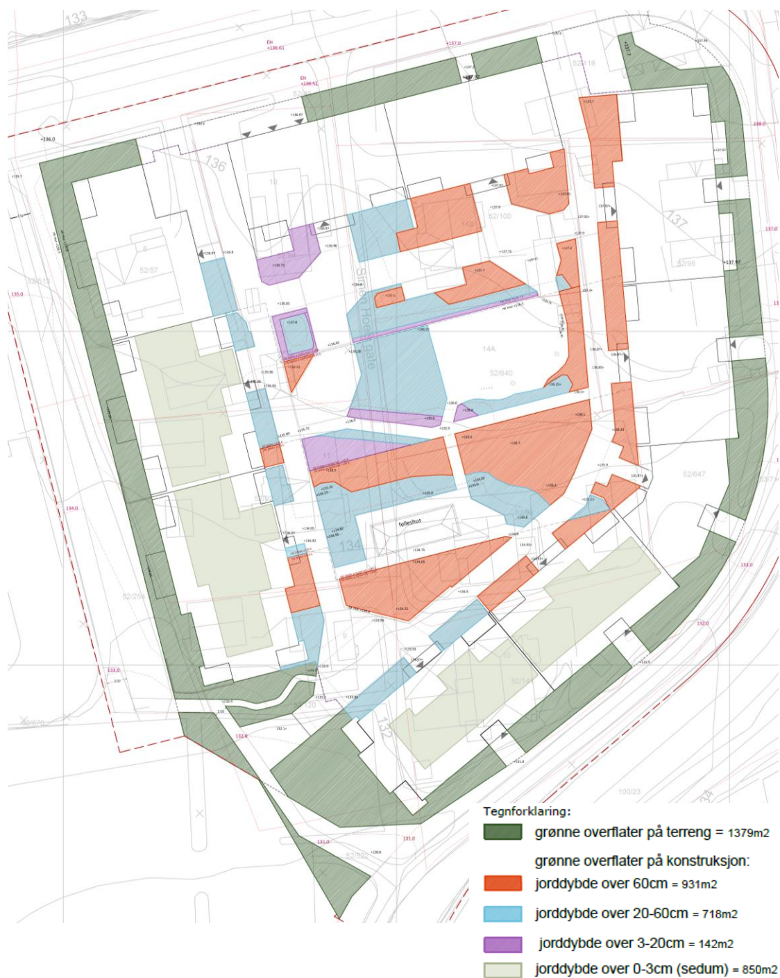
Figur 5 - oversikten viser fordelingen av de ulike jorddybdene i de grønne arealene i planområdet (Østre Linje)
