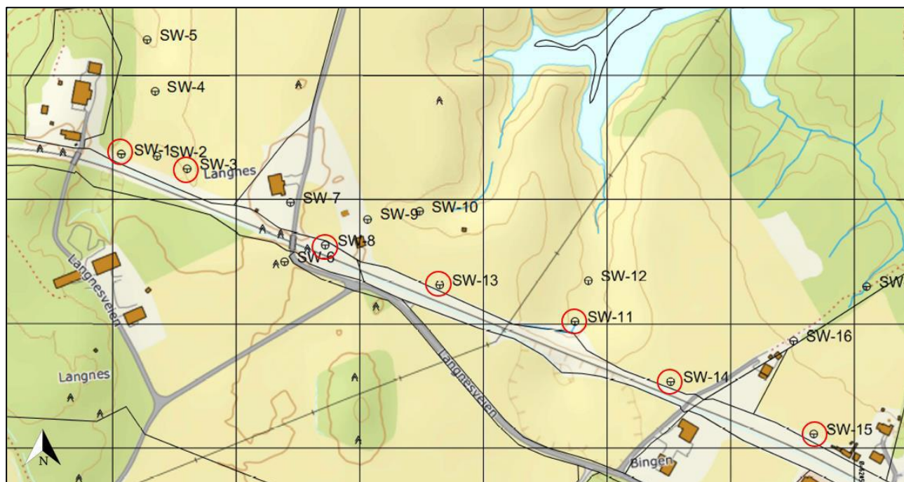
Figur 31: Figuren viser borpunkter for utførte grunnundersøkelser. Borpunkter hvor det også er gjort uttak av miljøprøver er vist med røde sirkler. (Kilde: Sweco Norge AS).
