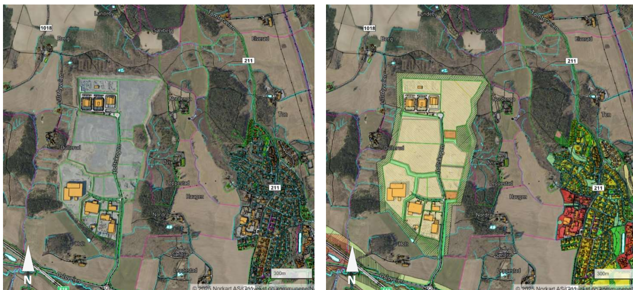
Figur 7 Utklipp fra kommune-web-kart med flyfoto t.v. og gjeldende plankart t.h. fra Indre Østfold kommune, 21.5.2025. Viser at vegetasjon er fjernet i regulerte områder og de er opparbeidet med nytt terreng.
