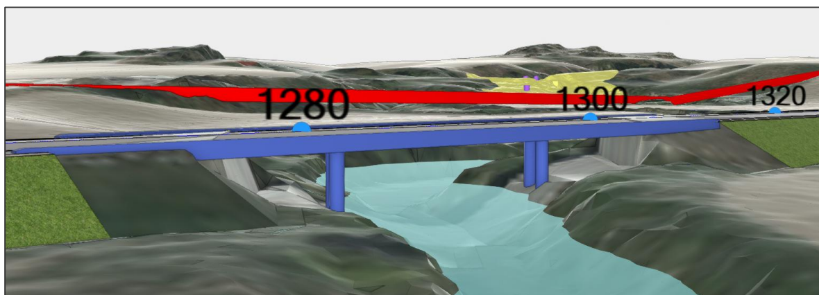
Figur 3-3 Plasstøpt platebru i tre spenn (alternativ 3b)
