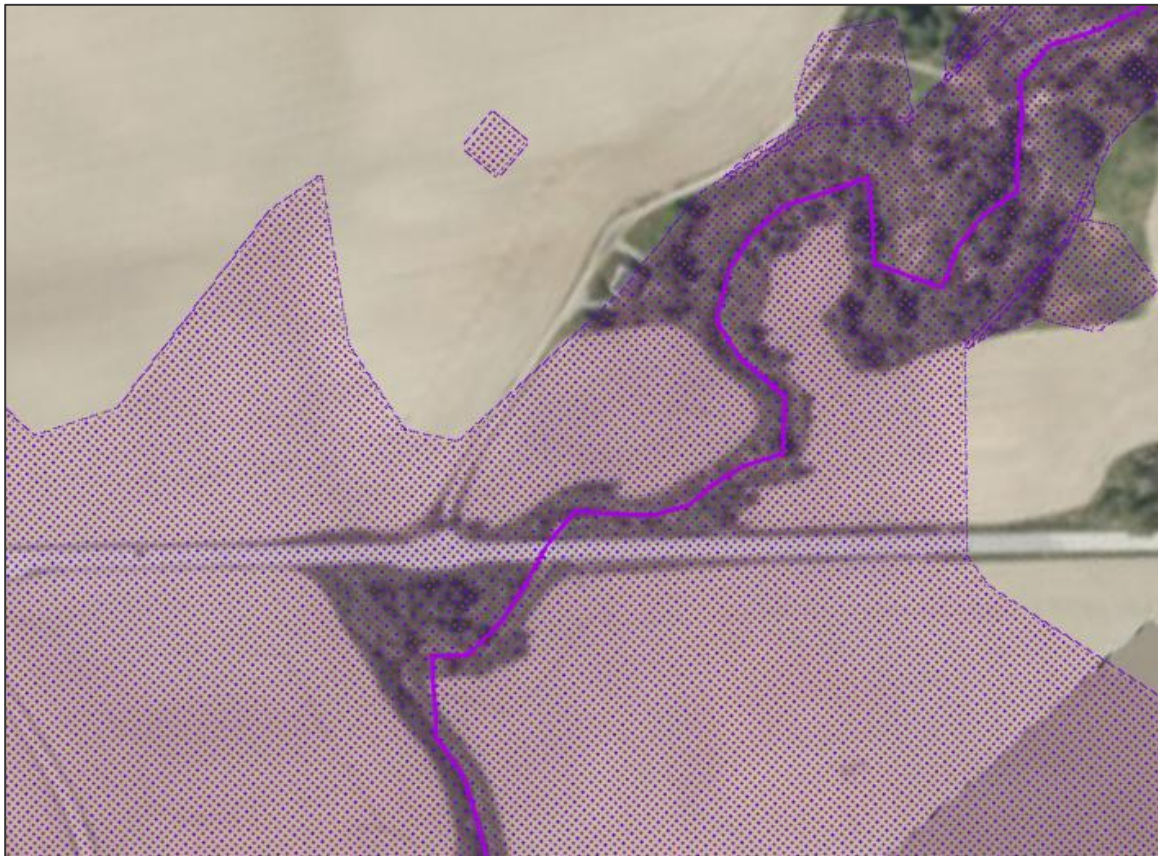
Figur 7-1 Aktsomhetssone for flom. Hulsbekken vist med lilla linje. Hentet fra NVE sitt aktsomhetskart
