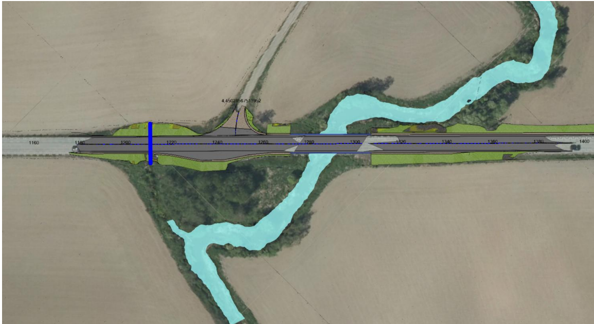
Figur 5-1 Eksisterende stikkrenne ved ca. profil 1210 vist med blått Avrenning fra eksisterende Huls bru går direkte til Hulsbekken.
