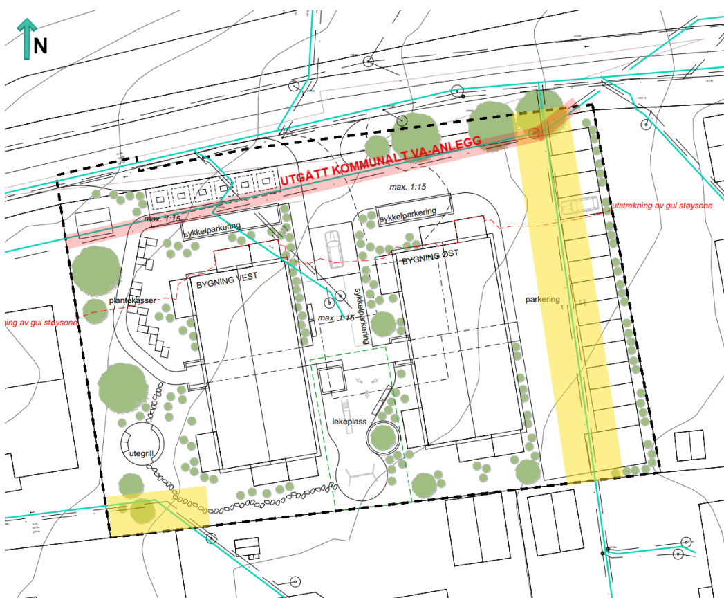
Figur 8 Situasjonsplan og eksisterende VA. Stikkledninger fra naboieendommer, som krysser Griniveien 17, er markert i gult. Utgått kommunalt VA-anlegg markert i rødt.
