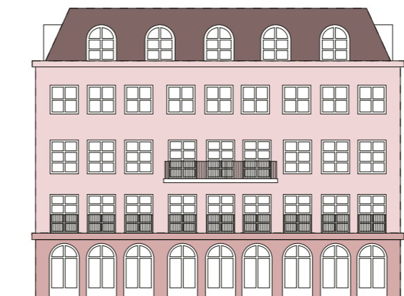
3.a ØKT KOMPLEKSITET OG DYBDE Fargesetting gir visuell tektonikk (mørkere i sokkel) Fransk balkong i 2. etg. Balkong som symmetrisk hovedmotiv
