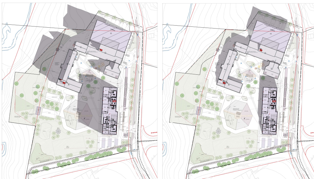
Figur 50 - Sol-skyggeforhold 21 sept kl 09 (venstre) og kl 12 (høyre)
