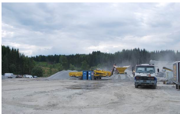
Aktivitet og drift i steinbruddet; pukkverk, steinknusing, sortering, pålessing, deponier for grus, pukk, finstoff og renskemasser.
