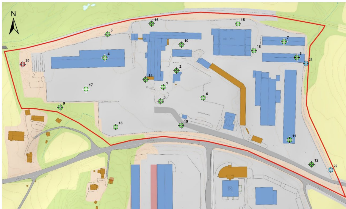
Figur 3. Oversiktsbilde over planområdet med planlagte prøvepunkt fra tilstandsrapporten utarbeidet av Rambøll i 2023. Grønne punkter illustrerer prøvepunkter for miljøprøver tatt i grunnen (jord), blå punkter illustrerer prøvepunkter i Resipienten Hyllibekken der det ble tatt sedimentprøver, og til slutt rødt punkt som illustrerer flis-haug som ble prøvetatt og analysert for miljøgifter.
