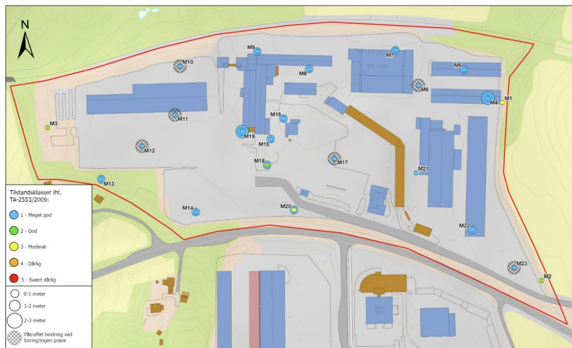
Figur 6. Oversikt over den kartlagte forurensingssituasjonen på planområdet. Høyeste påviste tilstandsklasse var i klasse 3 og kan sees i punkt M1 og M20. Forurensing i tilstandsklasse 2 ble påvist i prøve M2, M3 og M18. Resterende prøver var i tilstandsklasse 1.
