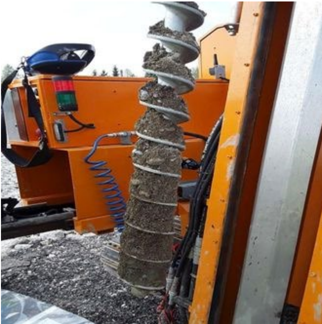
M7 0-1m, overgang fra sand og grus til leire ved 0,9m
