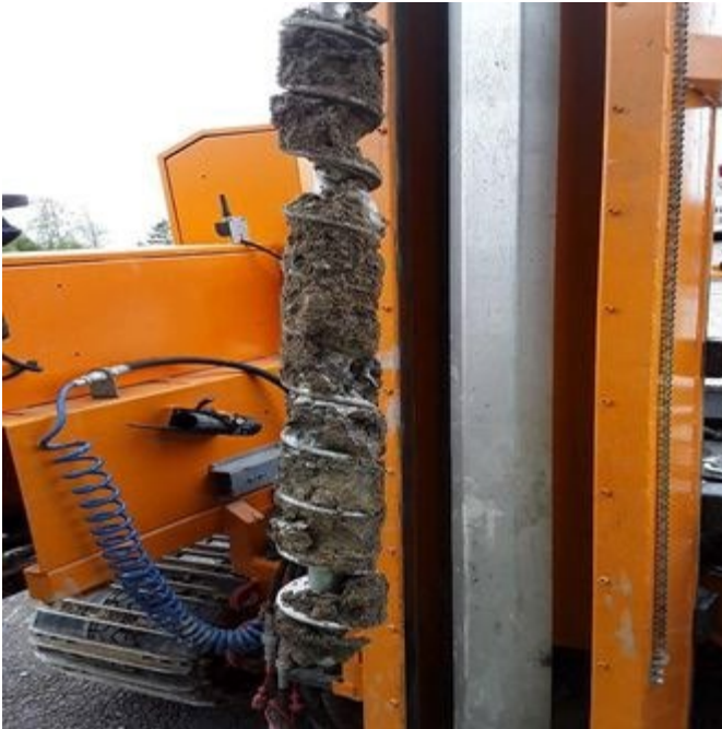
M19 0,5-1 meter, overgang til silt ved 0,5 m
