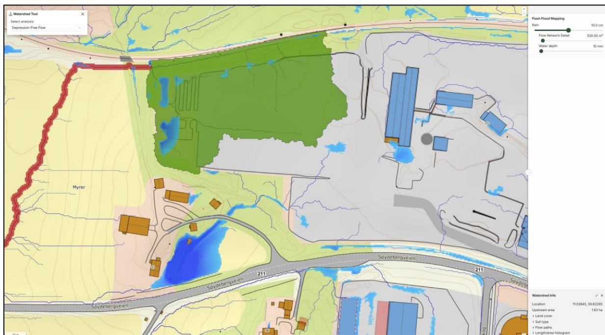
Figur 20 - andre del av nedbørsfeltet som renner mot vest på næringsfeltet
