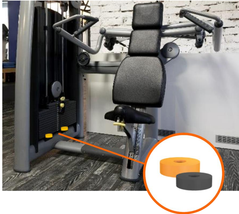
Figur 4 Prinsipp for elastiske klosser under vekstabel på treningsapparat med kabel (figuren er hentet fra Christian Berner).
