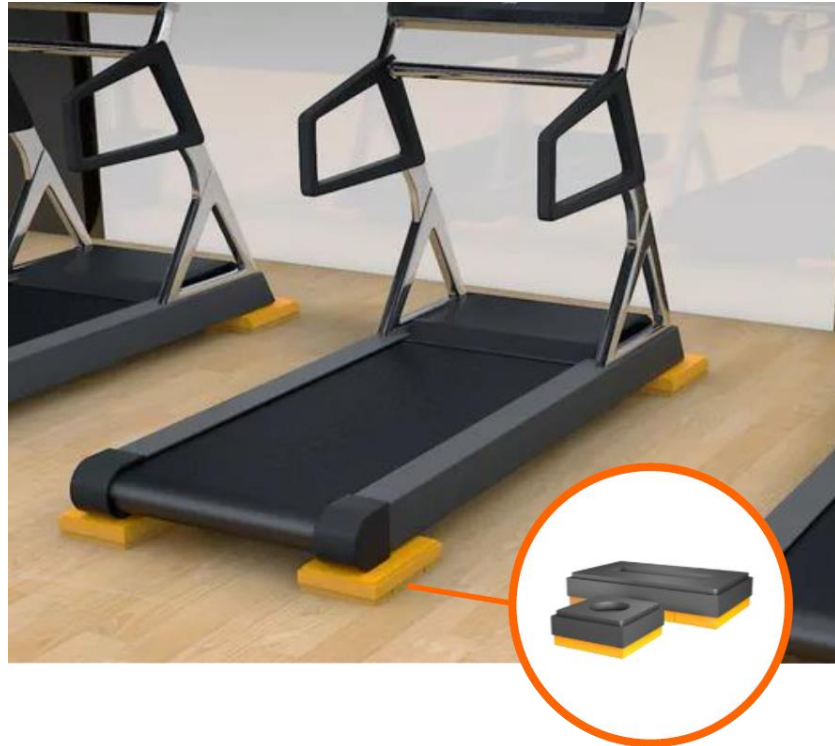
Figur 3 Prinsipp for elastiske klosser under tredemøller (figuren er hentet fra Christian Berner).
