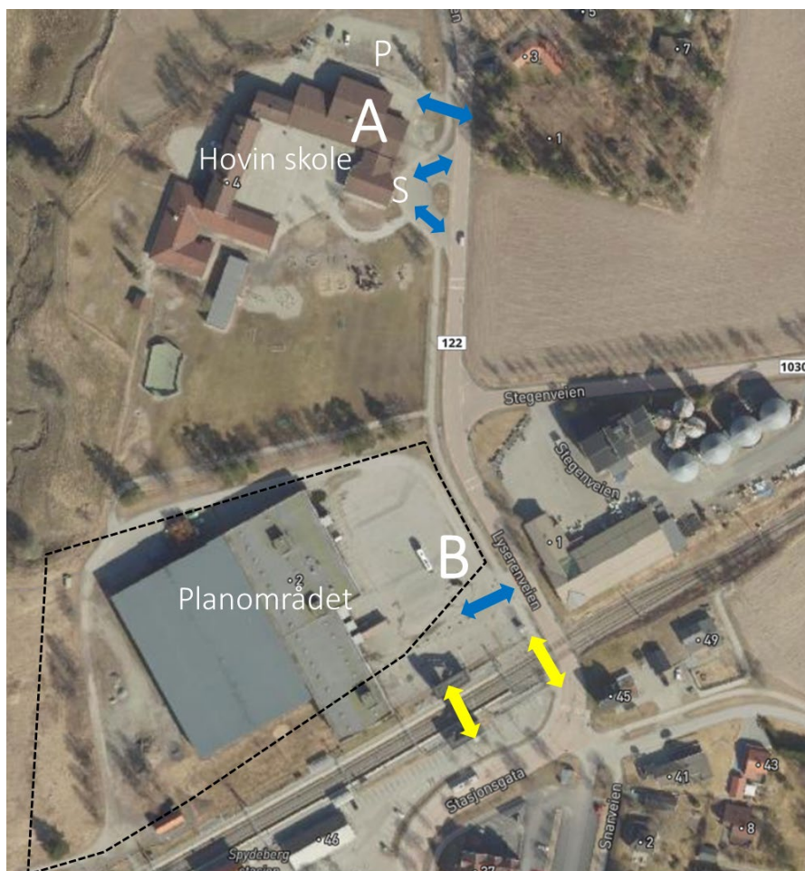
Figur 18 Markering av tellesteder for biltrafikk (blå piler) ved tellepunkt A fordelt på Hovin skoles ansattparkering (P) og snuplass for buss (S), ved lagerbygget (B) og gange/sykkel over sporområdet (gule piler over trappehus og planovergang). Planområdet markert med stiptet linje. Ill Civitas, kartgrunnlag kommune kart.com
