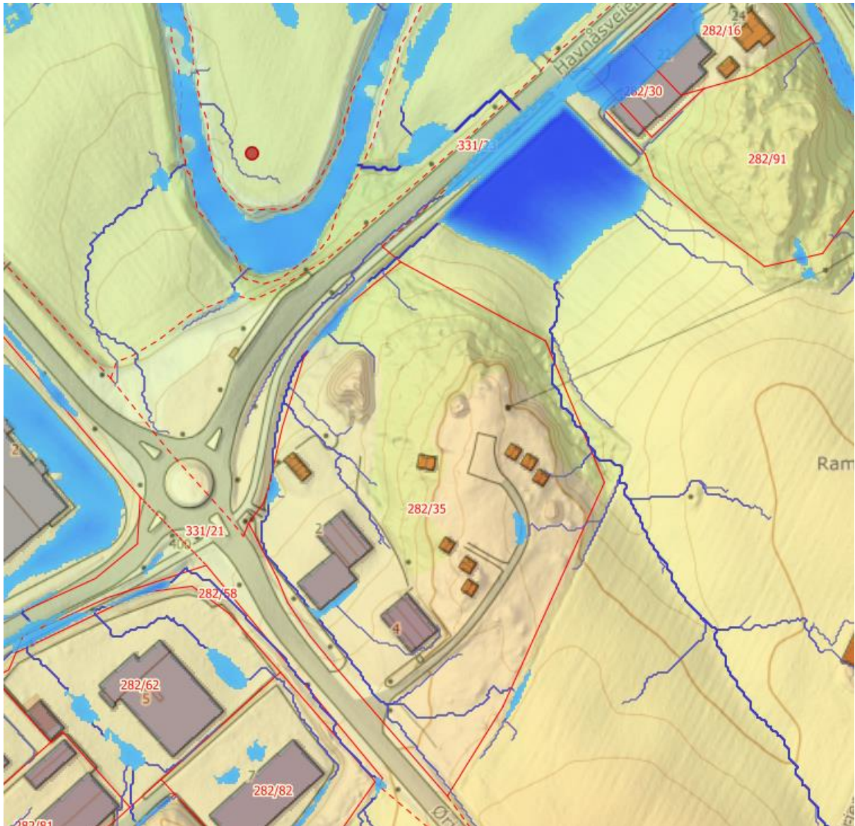
Figur 9: Figuren viser flomvei ved en flomhendelse. Simulert i SCALGO Live.
