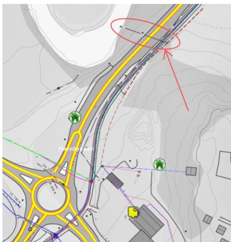
Figur 6: OV 400 stikkrenne under RV22 med utslipp i Hæraelva.
