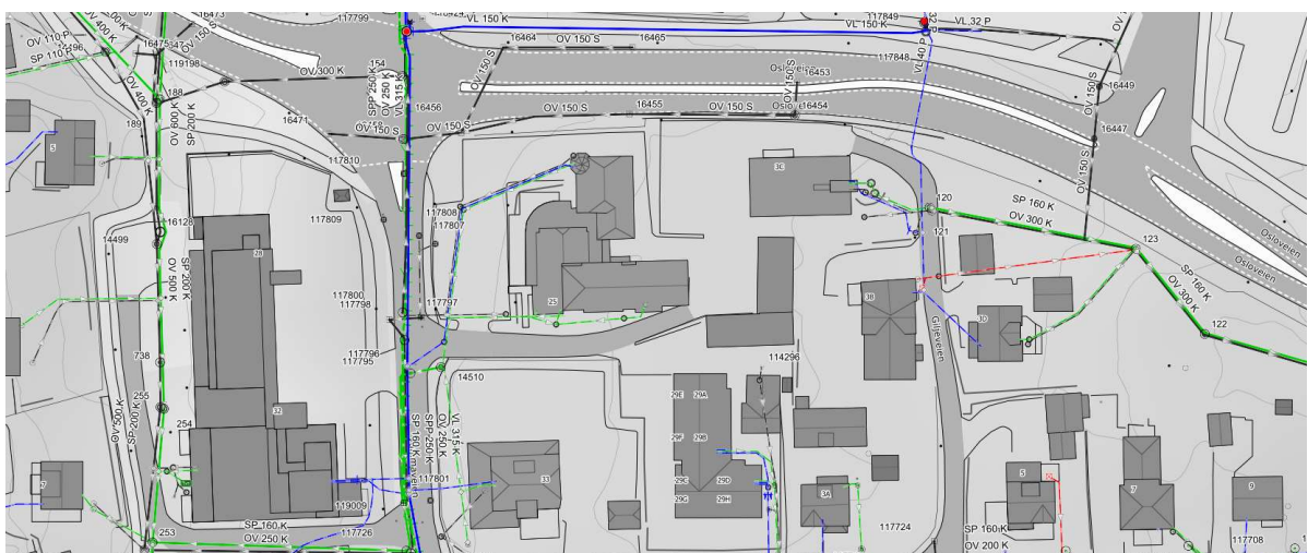
Figur 5: Eksisterende ledningsnett, hentet fra Gemini VA.
