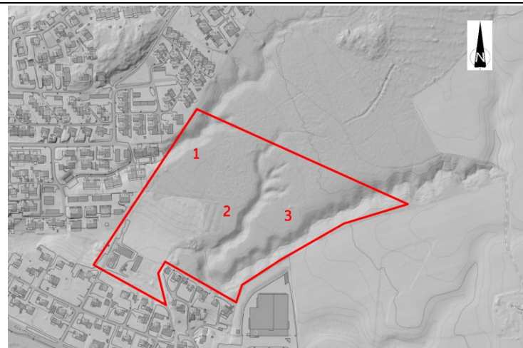
Bilde 2 og 3: Utsnitt fra geoteknisk rapport – Utredning av områdestabilitet. Tre raviner ligger delvis innenfor planområdet. Disse benevnes som 1 (vestre ravine), 2 (midtre ravine) og 3 (østre ravine).
