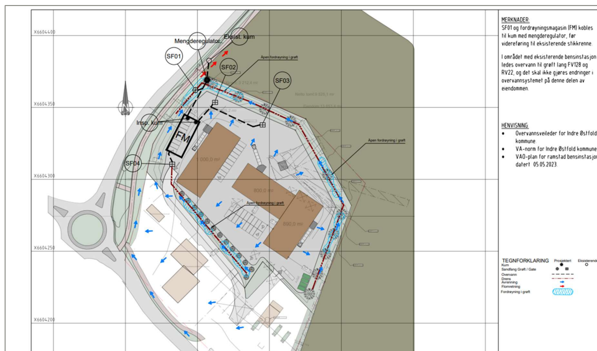
Prinsippkisse for overvannshåndtering, se vedlegg 6b
