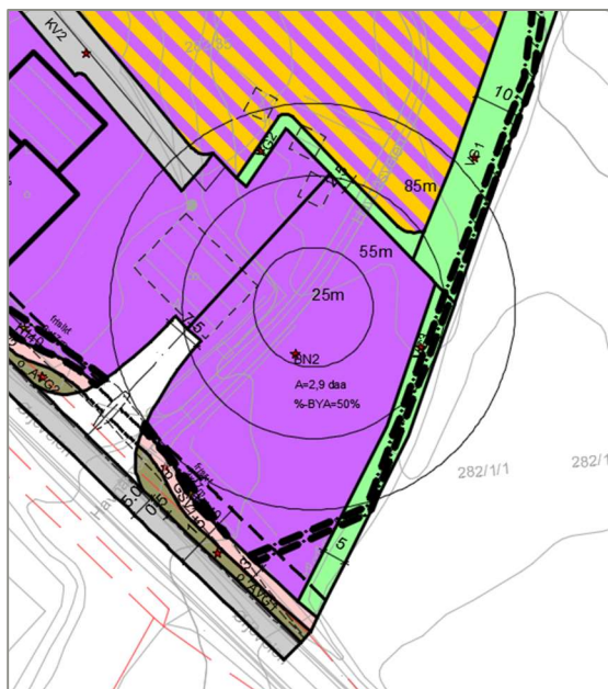
Arbeidsdokument som viser soner for gassanlegg
