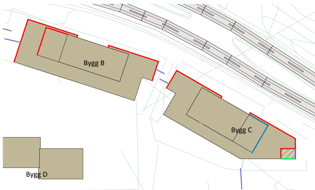
Figur 7: Skjermingsforslag, med skjermingshøyder grønn = 1,2 m, blå = 1,4 m, rød = 1,5 m og lilla = 2 m. Skjermer vist i rosa er skjermer tilknyttet balkonger fra og med plan 1 til og med plan 4 for bygg C.
